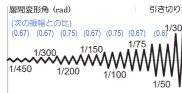
図1 耐力壁の性能評価における標準的な荷重履歴
