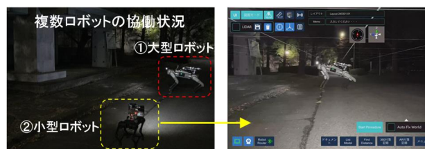
図9 夜間時の被災建物調査における 複数ロボット・カメラによる遠隔臨場支援状況
