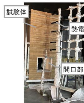
図2 ファサード試験装置
