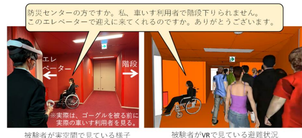
図1 車いす利用者のエレベーター避難のためのVRによる実験イメージ
