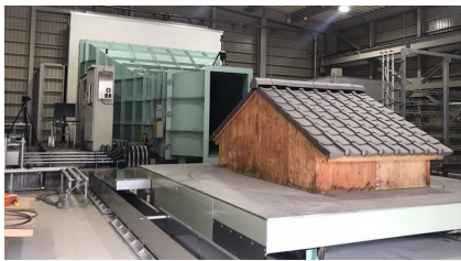
図1 実大強風雨発生装置の外観と屋根模型
