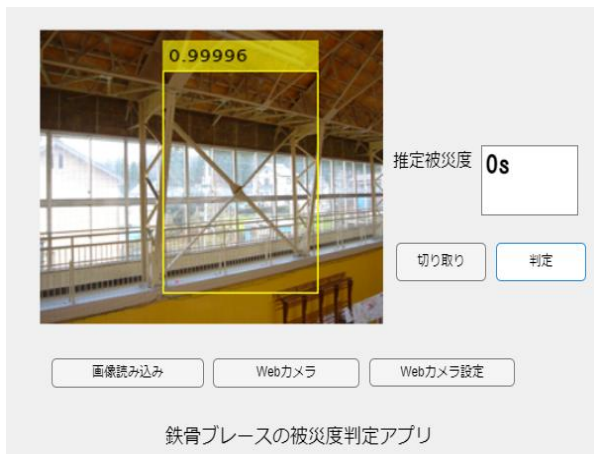
図1 タブレット端末を用いた被災度判定アプリ 3)
