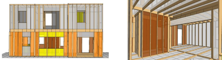
(a) 耐力壁の損傷状況（損傷大：オレンジ，中：黄色，小：緑）
