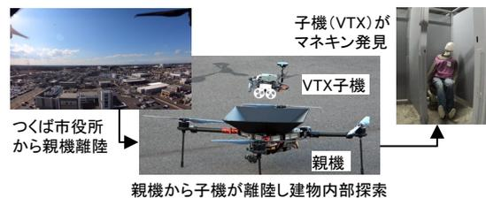
図-5 ④複合機による建物内部探索実験状況
