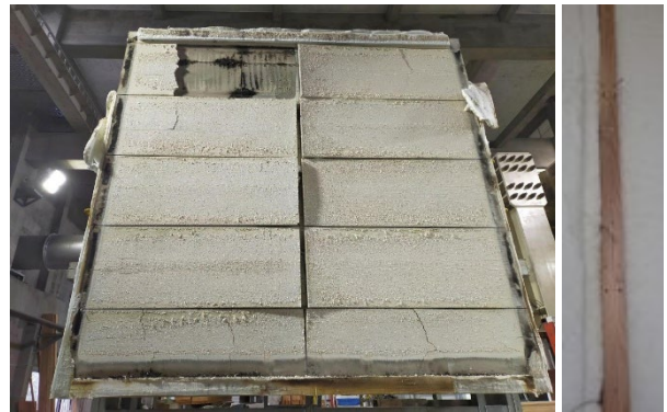
写真1 90分耐火構造試験体No.1(間柱に炭化等なし)
