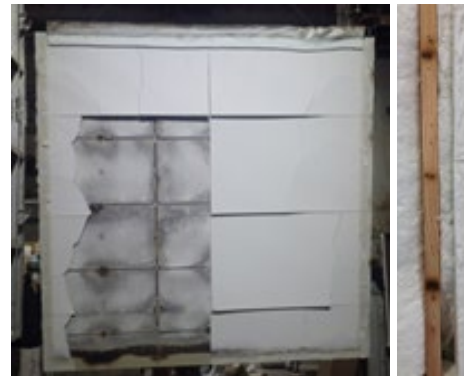
写真2 90分耐火構造試験体No.2(間柱に炭化あり)
