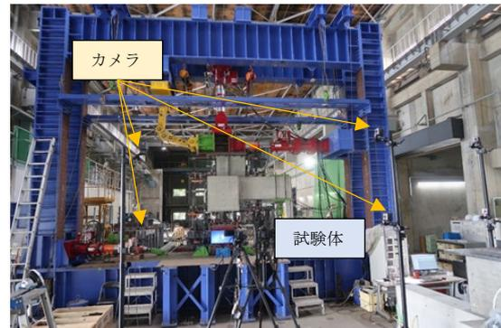
図6 静的実験における計測体制
