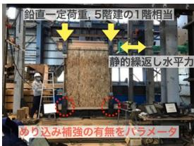
図7 めり込み補強壁試験
