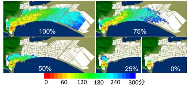
図 4 風速に応じた延焼状況（計算結果）
