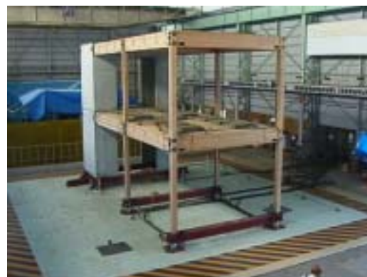
写真 1 平面ハイブリッドの振動台実験
