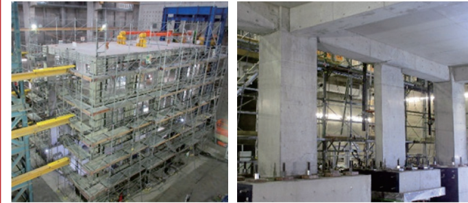
鉄筋コンクリート造実大3層架構の構造実験 Structural loading test on full-scale 3-story reinforced concrete frame
