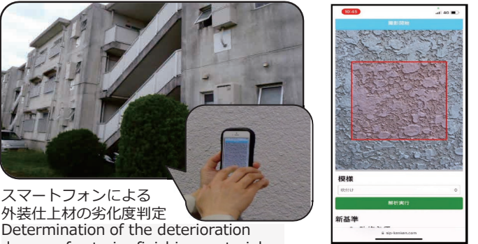
スマートフォンによる外装仕上材の劣化度判定 Determination of the deterioration degree of exterior finishing materials 画像診断を用いた外装仕上材の劣化度評価による鉄筋コンクリート造建築物の維持管理手法の高度化 Improving maintenance methods for reinforced concrete buildings by evaluating the deterioration of exterior finishing materials using image diagnosis
